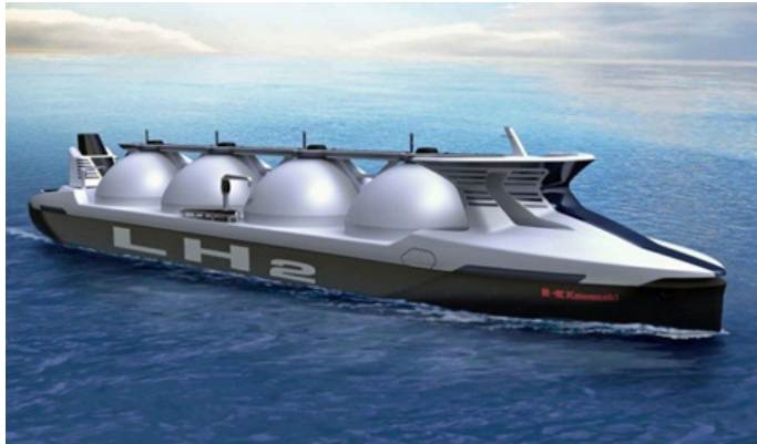
Figure n°18 - Projet de navire japonais pour le transport d'hydrogène liquide en provenance d'Australie - capacité 2500 m 3 liquide 25
